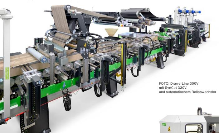
Automatische Formatverstellung: Umrüsten des Ummantelungsbereichs in maximal 6 Minuten
